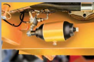
Suspensión oleo-neumática de serie. Suspension oléopneumatique de série. Default oleo-pneumatic suspension.
