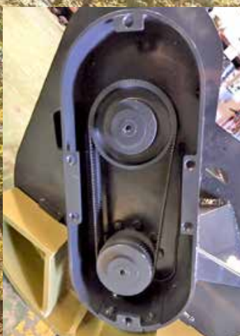
Poleas y correas dentadas EAGLE con auto centrado, altamente resistentes En CAB-FAW.
