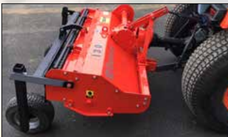
Fresadora Terraland FFLP para trabajos de limpieza de algas sobre balsas de plástico
