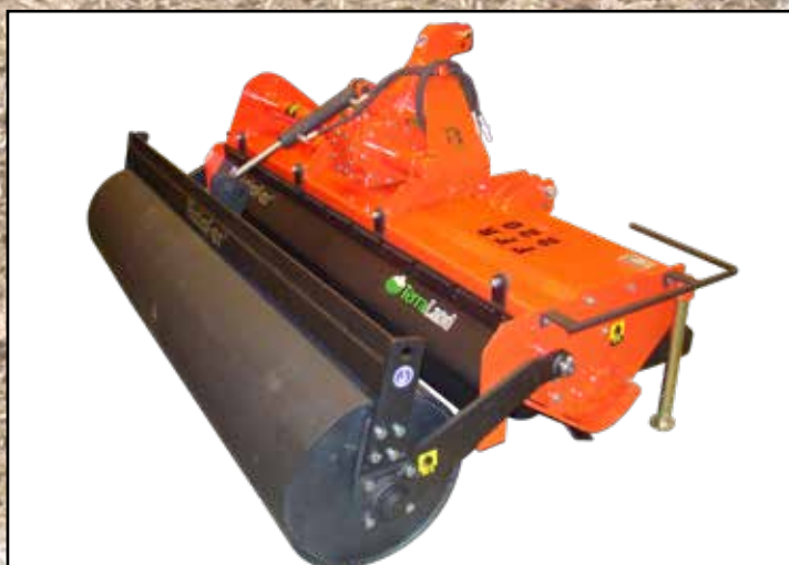
Disposición del rodillo liso de 500 mm en Terraland FFRP
