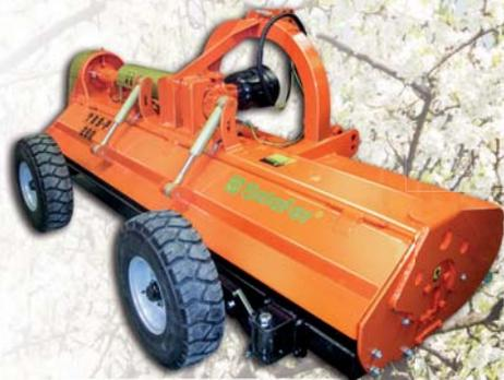
Trituradora con ruedas neumáticas en sustitución de rodillo.
