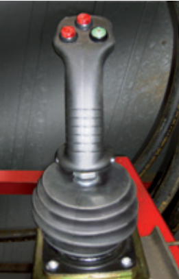
Joystick hidráulico de baja presión de serie Joystick hydraulique à basse pression de série Joystick handlink system default
