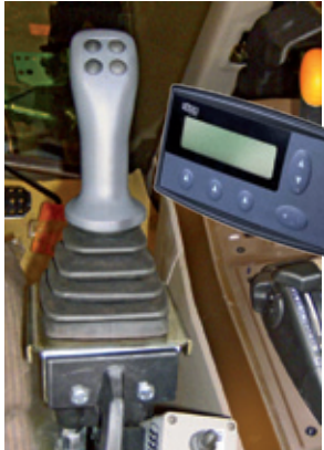
Opción: Mando IQAN con pantalla digital y ordenador de abordo. Optionnel: De contrôle IQAN avec affichage numérique et l'ordinateur de bord. Option: IQAN control with digital display and trip computer.
