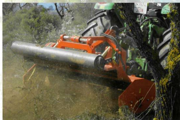
En trituración de ramas de olivar y almendros, el portón trasero se equipa con rejones traseros en la puerta para recoger todo material de pequeño calibre
