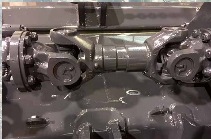
Detalle del sistema de transmision
