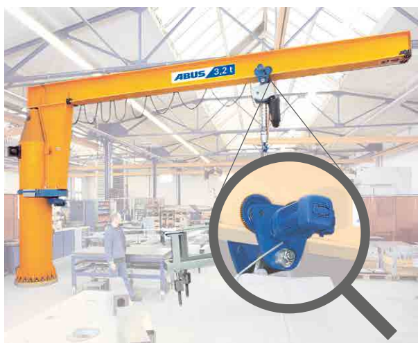
Traslación eléctrica del carro (fig. 1)
