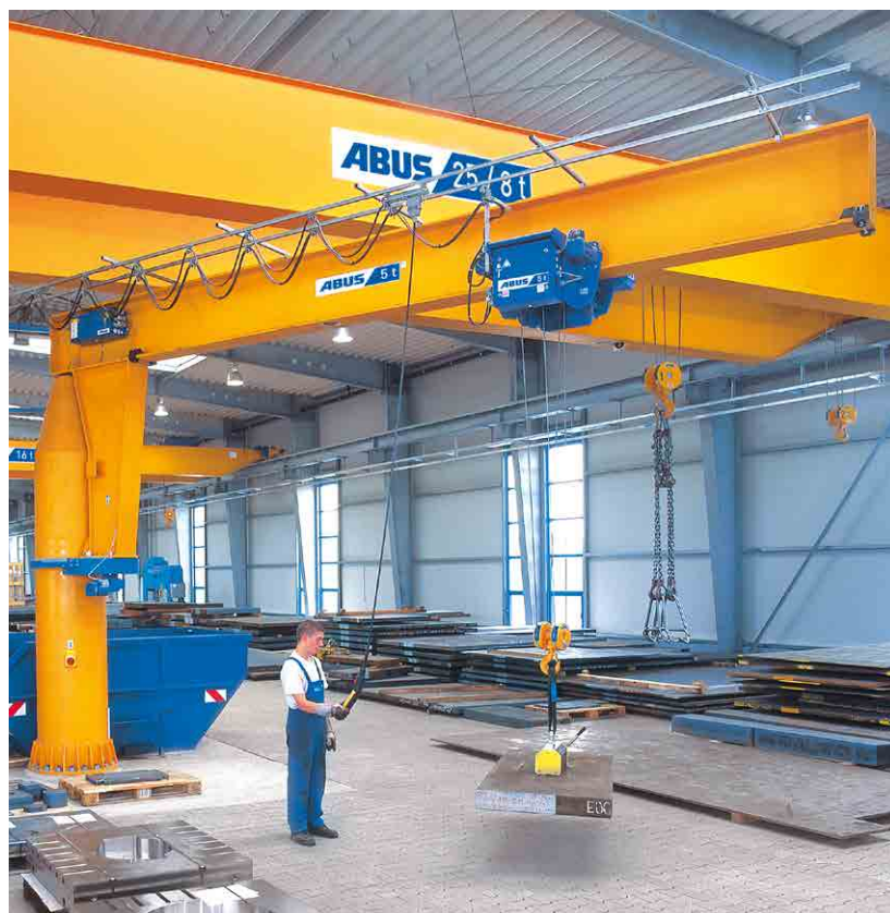
Grúa pluma de columna VS con polipasto eléctrico de cable GM 1000
