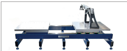
Mesa de moldes estándar sin mesa de nivelación con opción de soportes angulares forjados.
