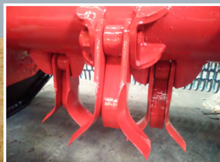
Cuchillas en Y con paleta cortadora Couteaux en Y avec palette coupante «Y» blades with cutting metal fin
