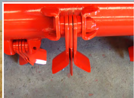
Cuchillas en Y con cuchilla recta Couteaux en Y avec couteau droit «Y» blades with straight blade
