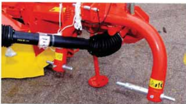
Cabezal de enganche de tres puntos, cat. I y II con ancho regulable (excepto en el modelo ROTO 135)
