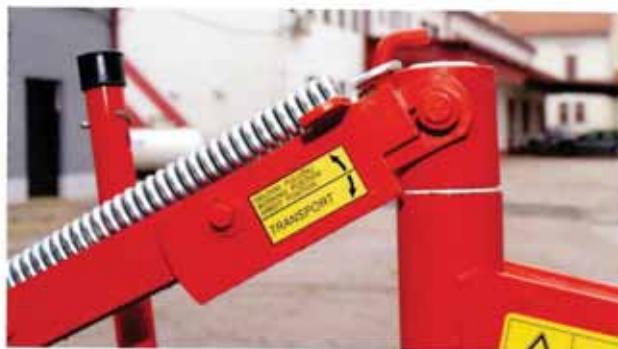
Bloqueo mecánico para transporte. Para adaptarse perfectamente al suelo, cuenta con un muelle que se encarga de la distribución del peso (Excepto en el modelo ROTO 135)
