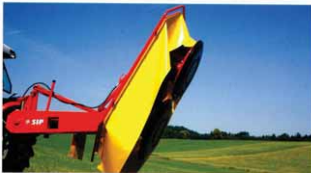
Los modelos ROTO 165, 185 y 220 cuentan con un dispositivo hidráulico de plegado como equipamiento opcional.
