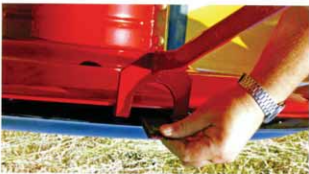
Rápida sustitución de las cuchillas (en segundos)
