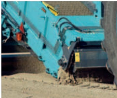
El rodillo recogedor conduce los residuos a la cinta de cribado. La posición del rodillo recogedor y el ajuste de la profundidad de la cuchilla se adaptan a la consistencia de la arena.
