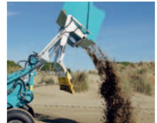
Con una altura de descarga de 2,60 m, el depósito colector de la BeachTech 2000 se puede descargar fácilmente en un camión o un container.
