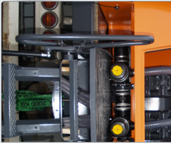
La ubicación del compartimento de la unidad de control permite un acceso rápido al mismo además de a las válvulas y las bombas de salmuera.
