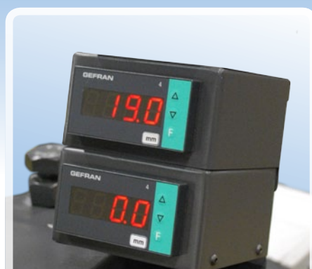
Visualizador digital de cota para indicar la posición de los rodillos curvador y/o inferior
