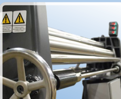
Dispositivo de curvado cónico incluye regulación diagonal del rodillo curvador, calzo corredizo y volante con esfera de registro
