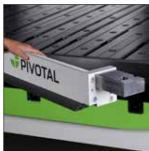
Abra la viga cuando haya terminado la secuencia de plegado.
