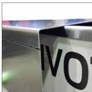
Es fácil fabricar perfiles cerrados con una sola soldadura.
