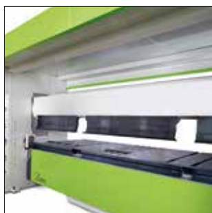
Viga de plegado en posición baja antes de pinzar el material.
