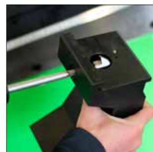
Herramientas fraccionadas con sistema de bloqueo rápido en la viga combi.
