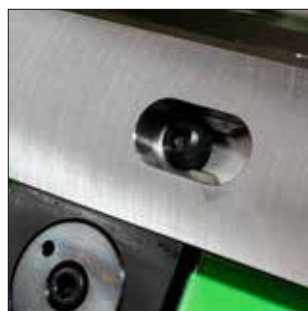
Herramienta de cambio rápido (estilo bayoneta) y ajuste de la compensación.
