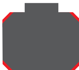
Slitta con quattro guide a V.
