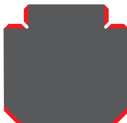
Slitta con sei guide a V.
