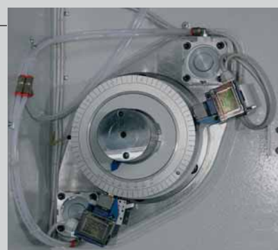
Gruppo camme e cilindri cambio corsa Cams group and stroke change cylinders
