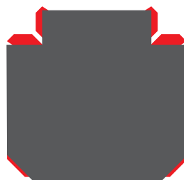
Slitta con sei guide a V.
