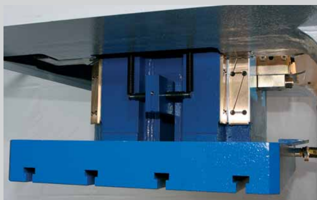
Particolare slitta con cave a "T" "T" slots slide detail
