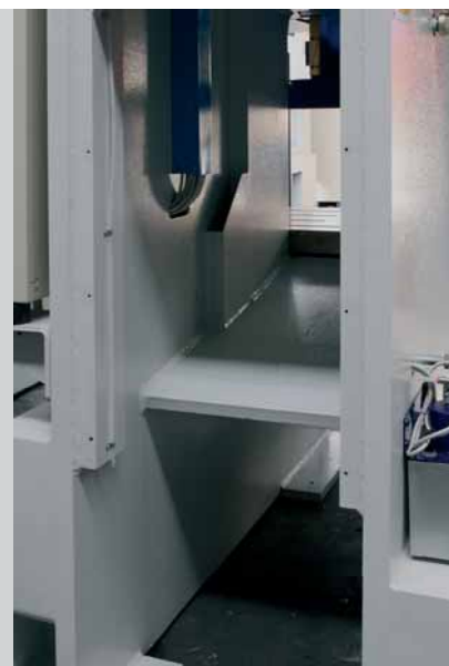
Retro pressa con scivolo per scarico sfridi Machine back side with chute for scraps discharge
