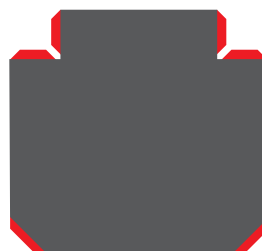
Slitta con sei guide a V.
