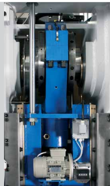
Gruppo cambio corsa-slitta motorizzata Motorized slide-stroke change unit
