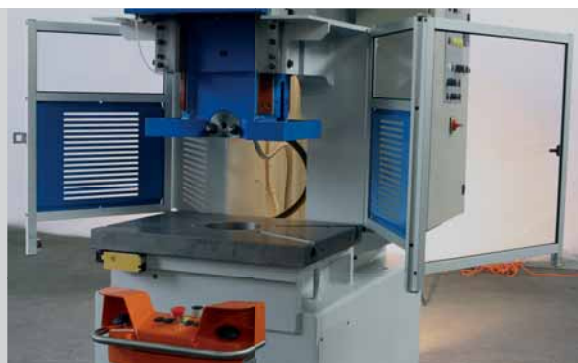
Barriere di protezione completamente apribili Protection barriers that can be completely opened
