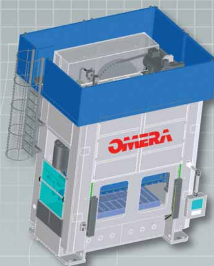
Pressa meccanica monolitica a doppio montante da 400 tonnellate con tavola 2000 x 1250 e cinematismo rallentato soft-blanking.
