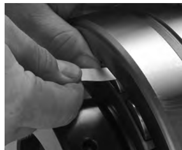
Fig. 18. Medida del RIC antes de la instalación.
