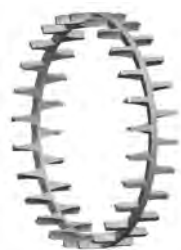
Fig. 7. Jaula de latón maquinado de una pieza, tipo saliente y con desplazamiento de rodillos.
