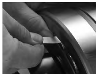
Fig. 14. Medida del RIC antes de la instalación.
