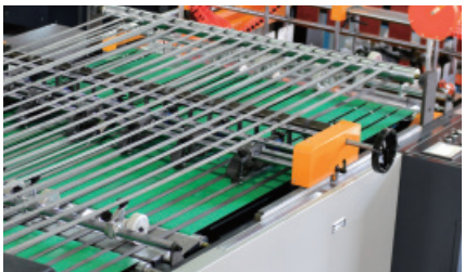
三次输送带传送（防撞纸压痕线） 3 TIMES DELIVERY(NO IMPRESSION LINE)
