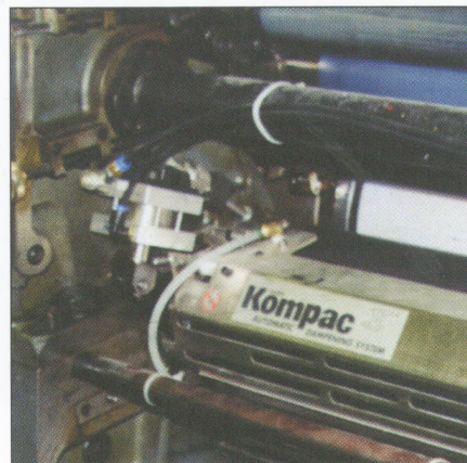
El mando neumático de conexión y desconexión del grupo mojado se encuentra en el panel de control de la máquina.
