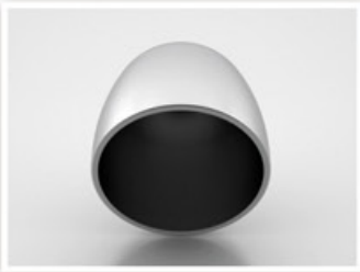
CONTENEDOR PARA TÈ M: acero inoxidable / 0,8 mm grosor D: Ø 128 mm O: recortadura y rebordeadura
