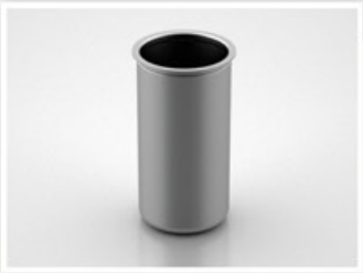
FILTRO DEL ACEITE M: acero normal / 2,0 mm grosor D: Ø 115 mm O: recortadura y conformadura
