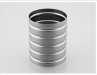
FILTRO DEL ACEITE M: acero normal / 2,0 mm grosor D: Ø 115 mm O: recortadura y conformadura
