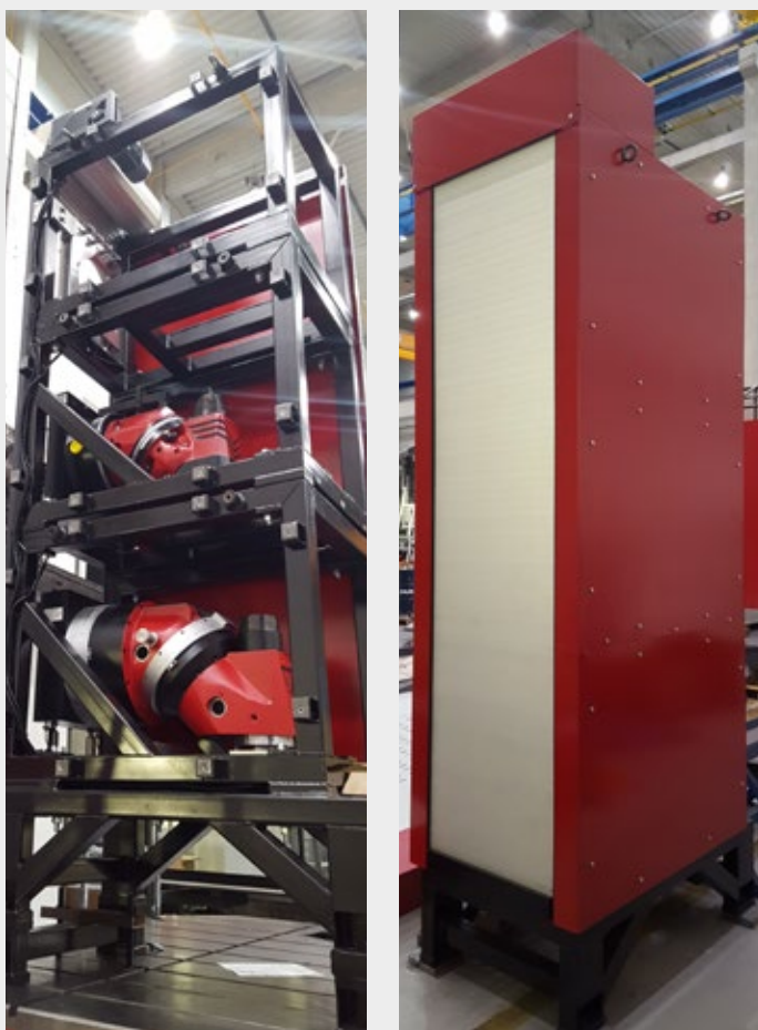
ESTACION PICK-UP PARA MANDRINADORAS TIPO PISO
