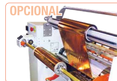
Módulo Digital HotStamp®: Dispositivo multifunción que permite impresión de oro, plata, gran variedad de colores metálicos, barniz, barniz reserva y efectos de hologramas.
