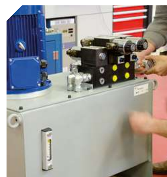
MONTAJE DE MINICENTRAL POWERPACK ASSEMBLY
