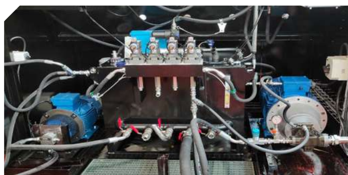
BANCO PARA PRUEBAS DE BOMBAS HIDRÁULICAS
