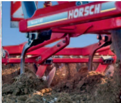
Dientes TerraGrip con rejas LD aflojan el suelo en la profundidad
