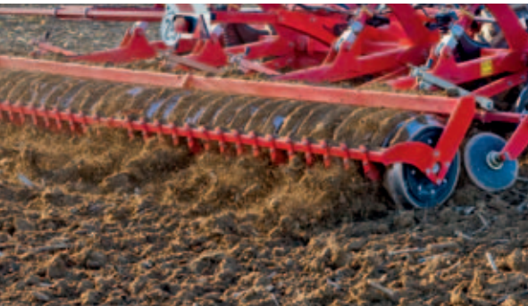
Compactador de discos de acero para la óptima consolidación en suelos pesados
