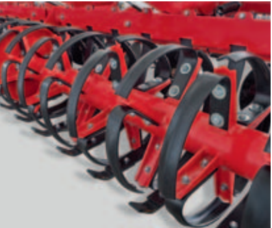
Compactador RollFlex para una consolidación profunda, aflojando la superficie.
