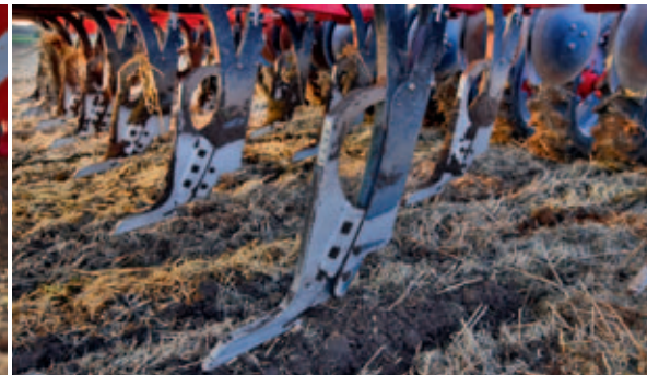
Rejas Ultra LD aflojan el suelo profundamente y no transportan terrones a la superficie ni en terrenos pesados.
