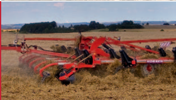
En vez de una rastra de 3 vigas, también discos niveladores y una rastra trasera están disponibles.
