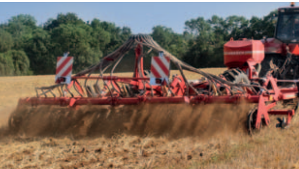
Terrano FM Con varios compactadores – aquí con el doble RollFlex
