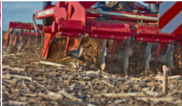
Sistema de discos para la mezcla superficial intensiva
