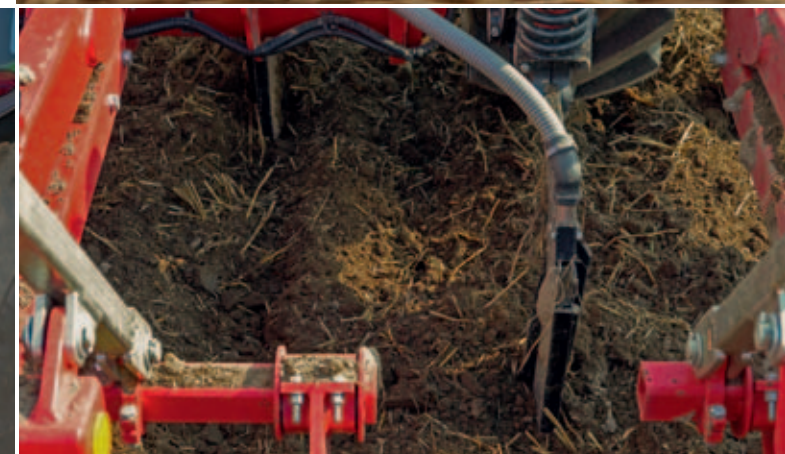
Dientes TerraGrip con latiguillos y ajuste de la profundidad de colocación para el depósito del abono.
