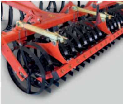
El compactador RollCut con sus elementos angulados consigue una superficie desmenuzada.
