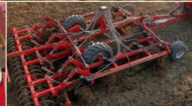
Terrano FM con torre de distribución y latiguillos para el abono
