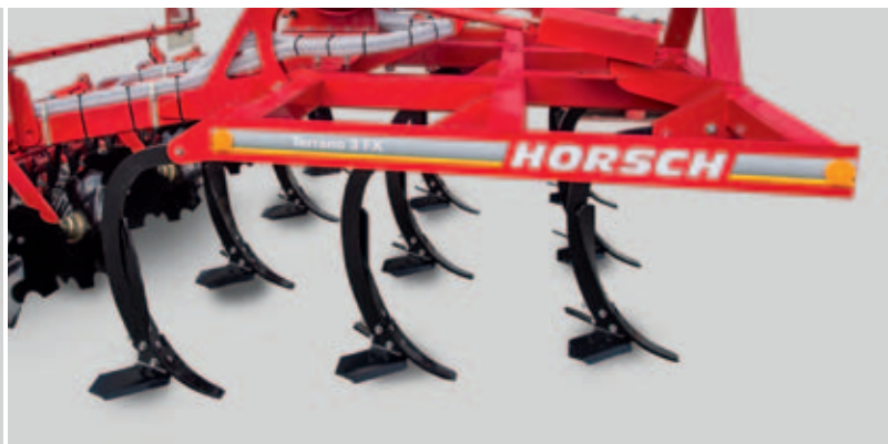
Terrano 3 FX con dientes con seguridad de cizalla
