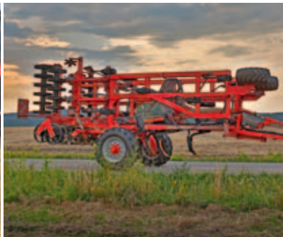
Chasis de transporte para maniobrar estrechamente y buenas características de conducción en carretera.
