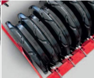
Compactador FarmFlex para una óptima consolidación en suelos ligeros y medios. Además es resistente a piedras.
