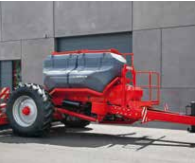
Großdimensionierte Bereifung am Säwagen: 520/85 R38
