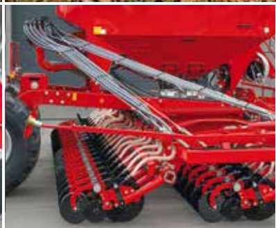
Hydraulischer Schardruck mit zentraler Verstellung
