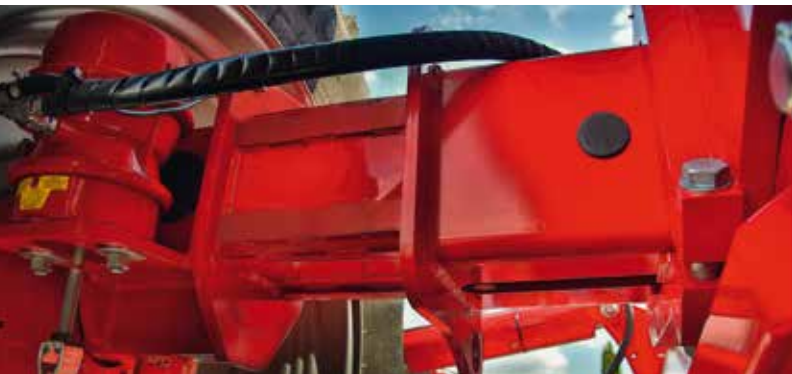
Serienmäßige Teleskopachse kompakte Transportbreite; Reduktion der Spurbelastung hinter der Schlepperspur
