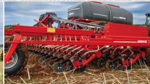
2-balkiger Scharaufbau für maximalen Durchgang
