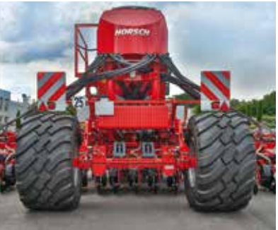
Optional: Bereifung 710/50-26.5 für maximale Aufstandsfläche
