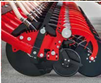
Druckrolle in der Saattrille für optimalen Bodenschluss des Saatkorns
