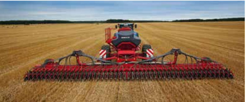
Hydraulische Gewichtsübertragung vom Säwagen auf den Scharrahmen: Gleichmäßige hohe Schardrücke über die gesamte Arbeitsbreite.
