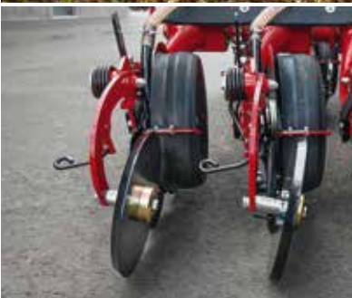
Schließrolle aus Stahl Wahlweise Stahl- oder Gummischließrollen
