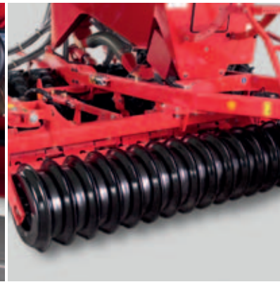
Disco de acero opcional para el compactador frontal 4 DC fijo
