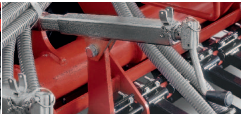
Ajuste de la presión de las rejas con progresión continua El ajuste manual aumenta la presión de los elementos de goma.
