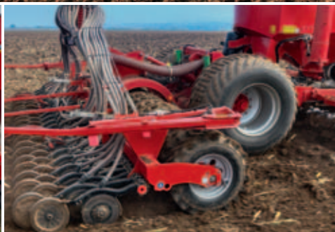
Chasis (sistema de transporte) Pronto AS Neumáticos de gran volumen (800/40-26,5) de tracción suave, cuidadosa con el terreno. Cuadro de montaje a tres puntos Cambio fácil y rápido de los equipos adicionales.
