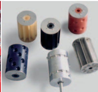
Rotores de dosificación precisos y de marcha suave Rotores fáciles de cambiar, para diferentes cantidades de semilla.
