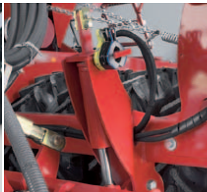
Ajuste exacto de la profundidad Fácil modificación de la profundidad de siembra por medio de Clips de Aluminio en el cilindro hidráulico.
