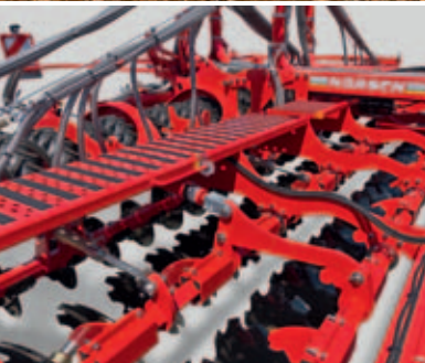
Estribos por encima del sistema de discos para un seguro acceso a cualquier punto de la máquina.
