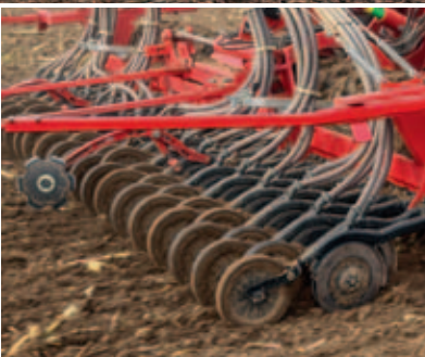
Reja TurboDisc Colocación exacta de la semilla aún en altas velocidades.
