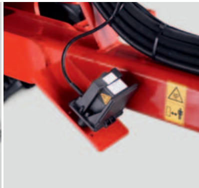
Sensor por radar Medición electrónica de la velocidad sin pérdidas de deslizamiento
