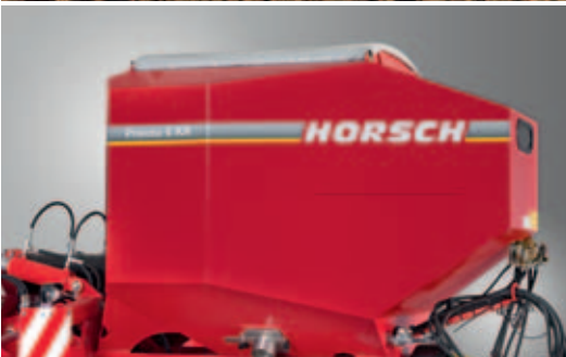
Siembra eficiente El tanque de semilla de la Pronto KR tiene una capacidad de casi 2.800 l.
