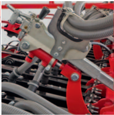
Opcional: regulación hidráulica de la presión de las rejas
