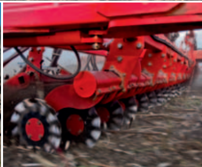
Las rejas onduladas cultivan la tierra eficientemente y son de tracción suave.
