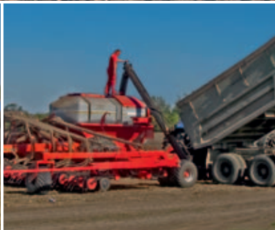
Alta eficiencia gracias al tanque de gran volumen y las grandes aberturas de relleno
