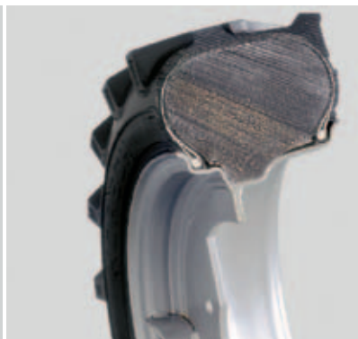
Relleno flexible de las ruedas Aumento de la estabilidad manteniendo el cuidado del suelo.
