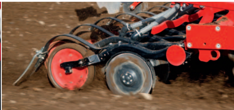
Reja de siembra de doble discos Discos rectos con cojinete interior que no requiere mantenimiento.
