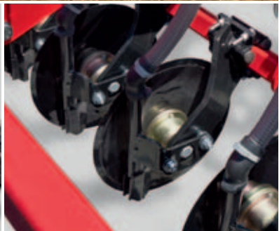
Las rejas de abono del sistema PPF de HORSCH introducen el abono en la profundidad exacta para el desarrollo óptimo del grano.
