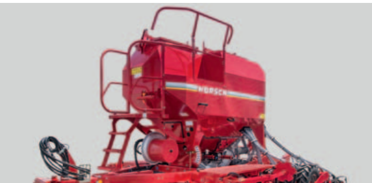
Depósito doble de gran volumen Hasta 5.000 l de capacidad del depósito, distribución 40/60
