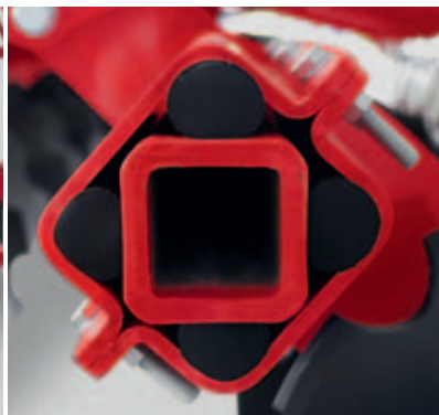
Enganche amortiguado contra oscilaciones Adaptación óptima al suelo y seguridad contra piedras
