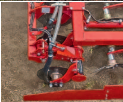
Reja de abono PPF Colocación exacta de abono entre los surcos de siembra
