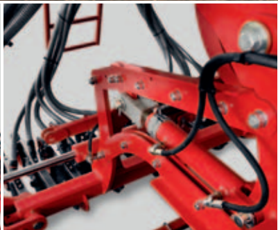
Ajuste individual de la profundidad de siembra gracias a los clips de aluminio.
