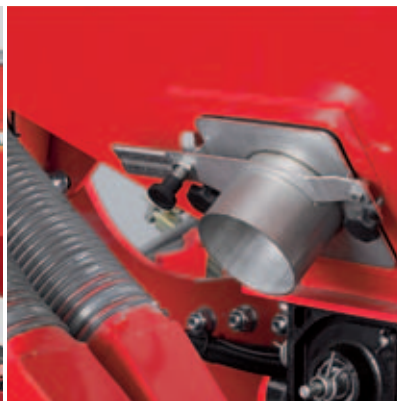
Vaciado del depósito
