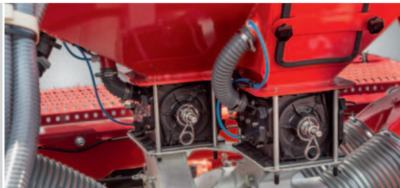
Dos dosificadores idénticos Dosificación exacta de las semillas y el fertilizante
