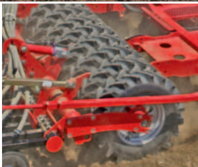
Compactador de ruedas con perfil optimizado Consolidación eficiente previo paso de cada reja
