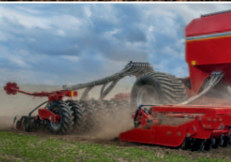
Chasis (sistema de transporte) Pronto AS Neumáticos de gran volumen (800/40-26,5) de tracción suave, cuidadosa con el terreno. Cuadro de montaje a tres puntos Cambio fácil y rápido de los equipos adicionales.
