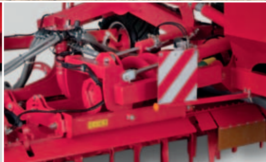
Segmentos de 3 metros de la grada rotativa están colgados oscilando para conseguir una adaptación óptima del terreno.
