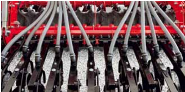
Disposición óptima de las rejas de siembra detrás de la franja del compactador. Cada reja de siembra se ejecuta exactamente en la franja que se ha consolidado.
