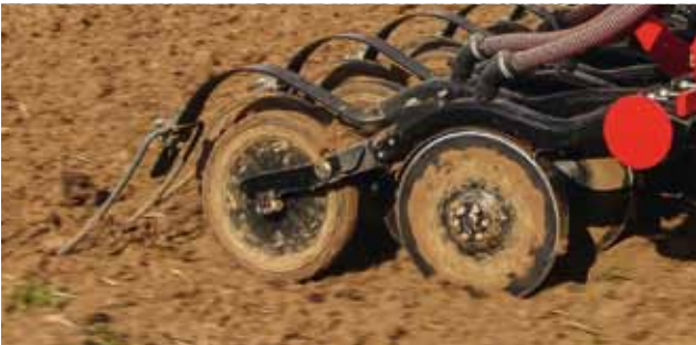
Una flexibilidad superior a la media (15 cm) en las rejas TurboDisc con ruedas de presión integradas permite un control de la profundidad preciso y regular. La alta presión individual de las rejas garantiza un funcionamiento suave incluso a altas velocidades.
