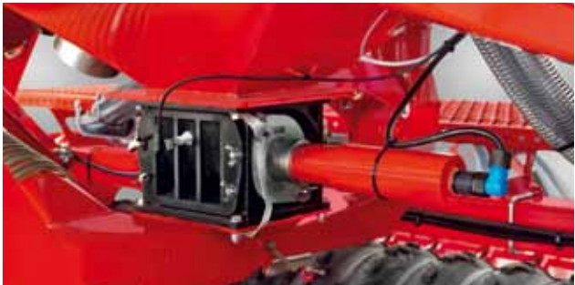
Dosificador E-manager (Express TD/Express KR) accionamiento eléctrico para la dosificación de la semilla. Permite una dosificación rápida, sencilla y exacta.
