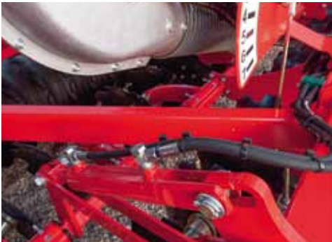
Regulación hidráulica de profundidad sistema de discos (DiscSystem) (opcional)
