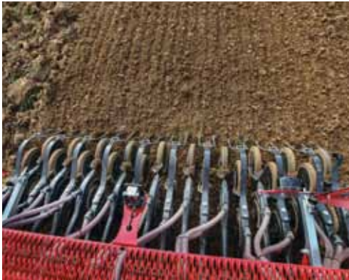
Rejas de precisión TurboDisc de la segunda generación para una colocación exacta de la semilla con alta velocidad. En todas las Express TD y KR.
