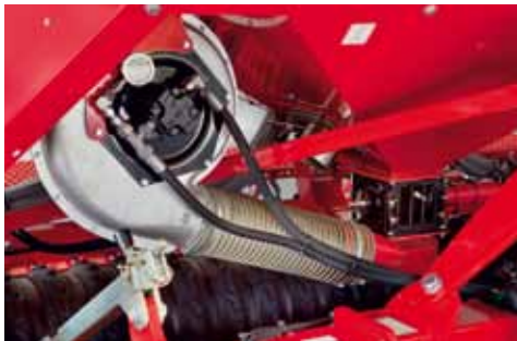
Accionamiento directo del soplador hidráulico
