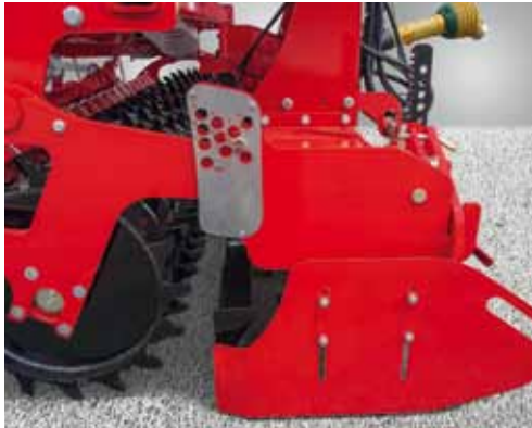
Ajuste de la profundidad de trabajo de la grada rotativa sencillo y fácil de entender
