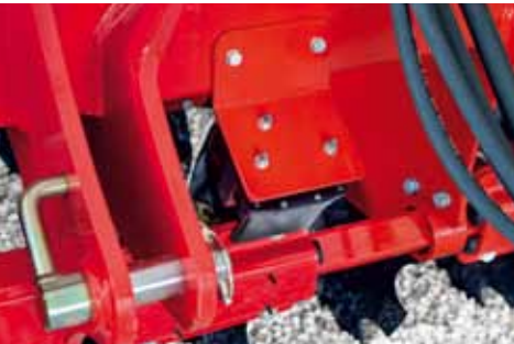
Sensor de radar para un registro exacto de la velocidad y para controlar la cantidad de semillas.
