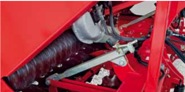
Ajuste de la profundidad DiscSystem a través de 2 sensores. Opcional: se puede hacer mientras se conduce a través de dos cilindros hidráulicos.
