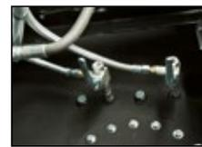
KIT VÁLVULAS 3 VÍAS PARA CONEXIÓN DE TANQUE COMBUSTIBLE EXTERNO (MANETA ÚNICA OPCIONAL)
