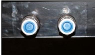
CONEXIÓN RÁPIDA PARA TANQUE DE COMBUSTIBLE EXTERNO.
