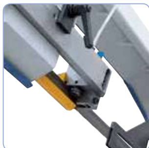
Guiado de la cinta mediante un sistema combinado de rodillos y piezas de carburo.
