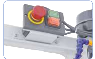
Interruptores de seguridad con desactivación en caso de caída de tensión y un botón de parada de emergencia independiente
