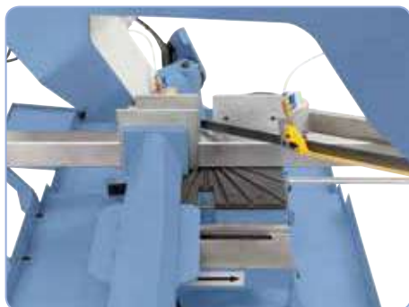
Mordaza desplazable, con bloqueo rápido para corte a doble inglete.
