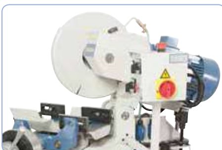
Cabezal de engranajes con giro a 90° hacia la derecha y la izquierda
