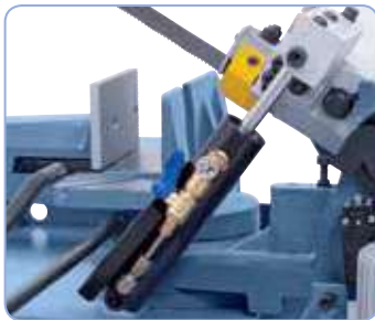
Cilindro hidráulico para un descenso suave del arco de sierra.
