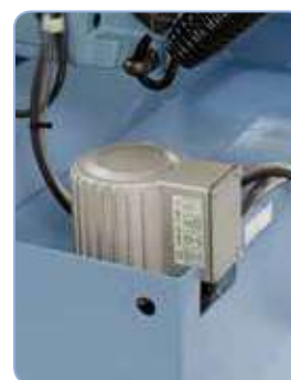
Potente bomba de refrigeración incluida en el equipo base
