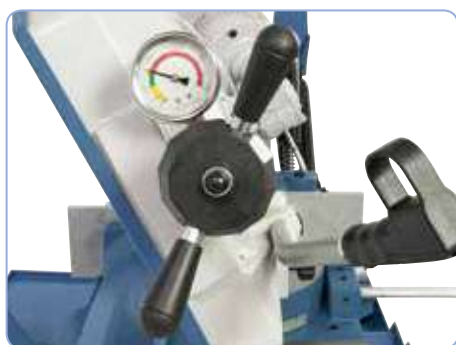
El manómetro de serie permite un ajuste óptimo de la tensión de la hoja de sierra.
