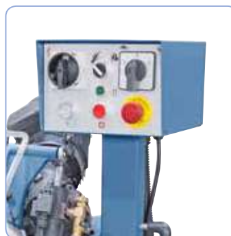
El panel de control montado en la parte frontal de la máquina permite trabajar cómodamente.
