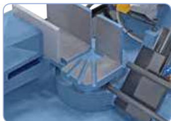
Arco de sierra giratorio para corte a inglete hasta 45°.
