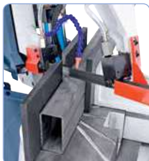
Mordaza desplazable, de amarre rápido para cortes a doble inglete
