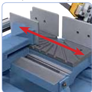
Mordaza desplazable, con bloqueo rápido para corte a doble inglete.
