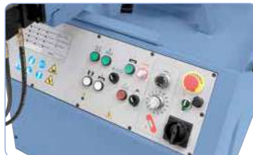
Conmutador giratorio para regular la velocidad de corte y válvula de control de la presión del soporte en el ergonómico panel de mandos
