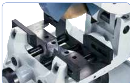
Mordaza maciza y autocentrante, con garras de sujeción con desplazamiento longitudinal.
