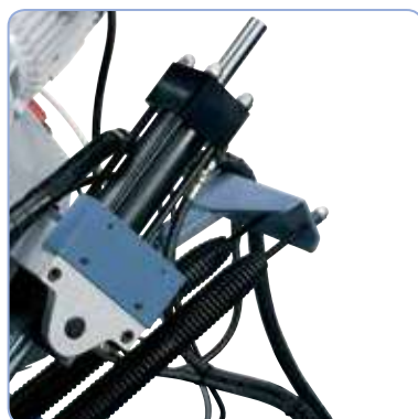
Cilindro hidráulico bien dimensionado, para trabajo continuado.
