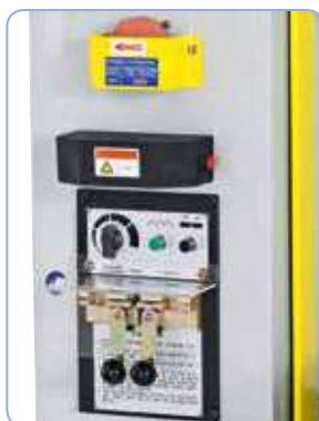
Incluye dispositivo para soldar, templar, cortar y afilar la cinta de sierra.
