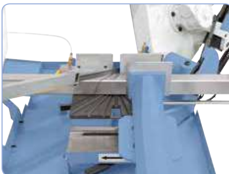
Guiado de la cinta mediante un sistema combinado de rodillos y piezas de carburo.
