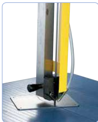
Guiado de la cinta de la sierra con rodamientos a bolas, ajustables a la altura de la pieza de trabajo.
