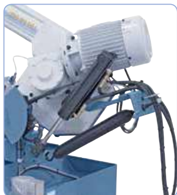
De serie con cilindro hidráulico para bajada continua del arco de sierra y desconexión automática al término del corte.
