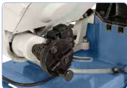
Presión de apoyo del arco de sierra con triple ajuste
