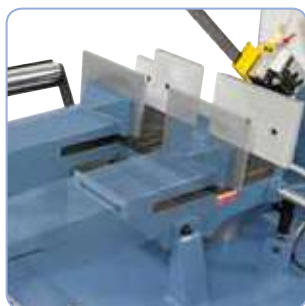
Mordaza de máquina desplazable y de amarre rápido para cortes a doble inglete
