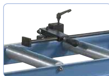
El tope de pieza puede escamotearse hacia arriba en cualquier momento
