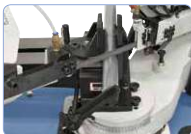
El arco de sierra giratorio puede realizar cortes a inglete y ajustarse de -45^\circ a 45^\circ .
