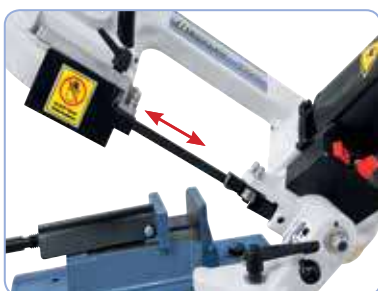
El guiado de la cinta de la sierra puede ajustarse según el ancho del material
