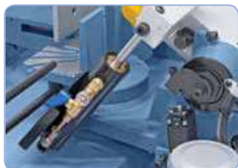
Cilindro hidráulico para un descenso continuo del arco de sierra.
