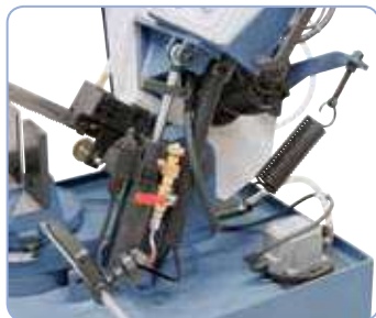
Cilindro hidráulico para un descenso continuo del arco de sierra.
