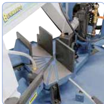
El arco de sierra puede girarse en los cortes a inglete de 90° a 60°.
