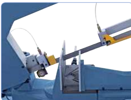
Guiado de la cinta mediante un sistema combinado de rodillos y piezas de carburo.
