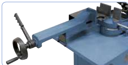
La mordaza fabricada en fundición gris y amarre rápido, óptimo para trabajos en serie.
