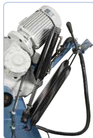
Muelle con palanca que permite cambiar a modo manual
