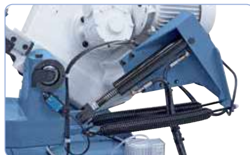
De serie con cilindro hidráulico para un descenso suave del arco de sierra.
