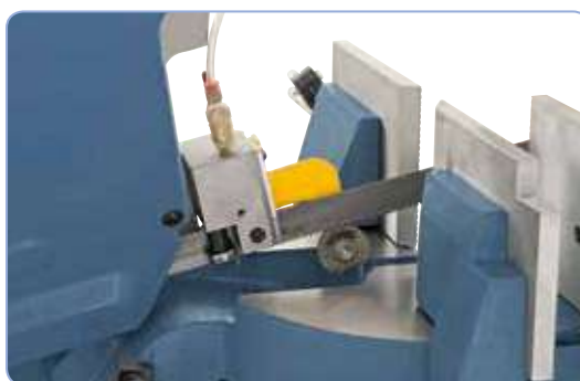
La combinación de guías de rodillos y placas de carburo previene el excesivo desgaste de la cinta
