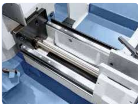
Guía lineal de precisión con husillo a bolas y potente servomotor para la máxima precisión de posicionado.
