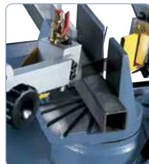
El arco de sierra puede girarse en los cortes a inglete de 90° a 60°.
