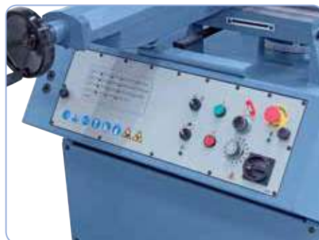
El panel de control montado en la parte frontal de la máquina permite trabajar cómodamente.
