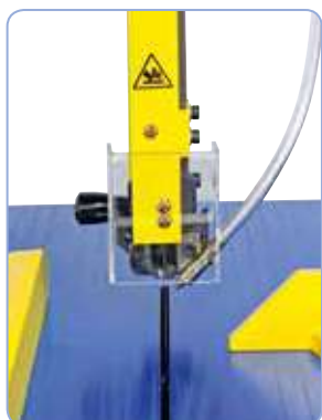
Incluye sopladora para una visión óptima sobre la línea de corte
