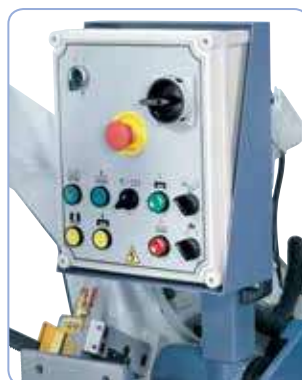
Clara disposición de los elementos de control en el panel de control inclinable
