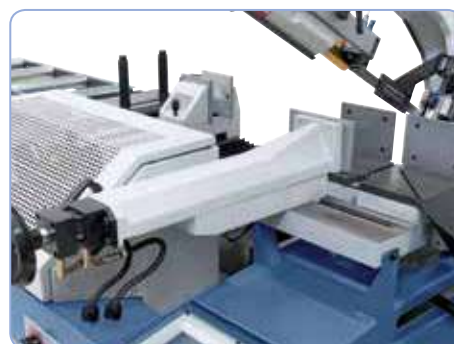
Mordaza hidráulica desplazable para corte en inglete.
