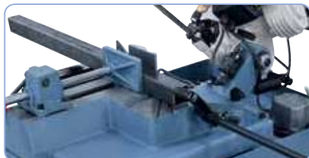
Sencillo ajuste de la mordaza mediante la palanca de amarre rápido
