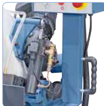
Cilindro hidráulico de grandes dimensiones para un descenso continuo del arco de sierra
