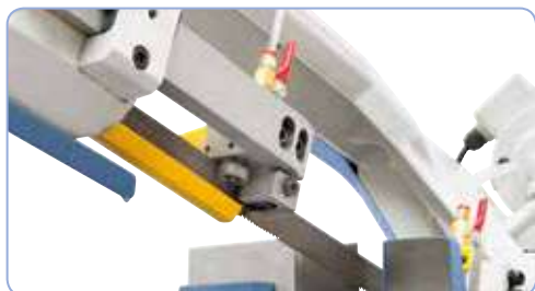
El sistema combinado de rodillos y piezas de carburo garantizan un guiado ideal de la cinta y, por lo tanto, resultados de corte óptimos.
