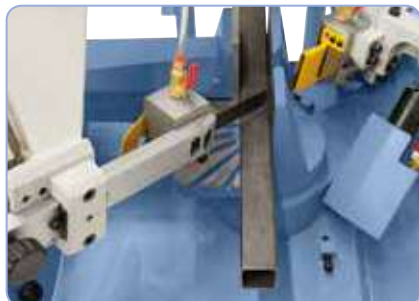
Arco de sierra inclinable para efectuar cortes en inglete de 90° a 60°
