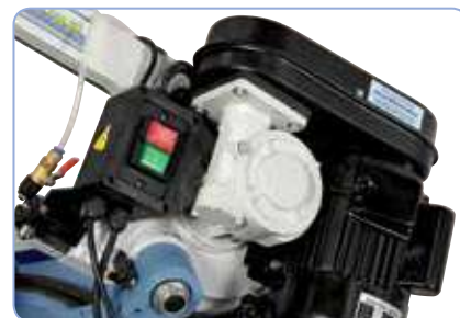
Mediante una correa trapezoidal puede cambiarse la velocidad de corte (24 / 41 / 61 / 82 m/min)
