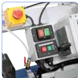
Disposición centralizada de los elementos de mando en el arco de sierra
