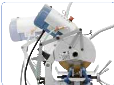
La cubierta de protección se abre automáticamente al bajar el cabezal de engranaje.
