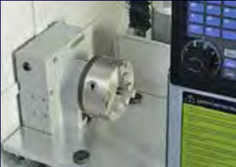
4º Eje neumático programable
