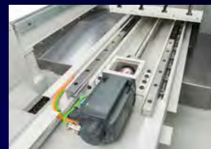
Guías Lineales en todos los ejes de la Gama LR
