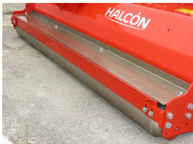
Detalle rodillo nivelador auto-limpiante
