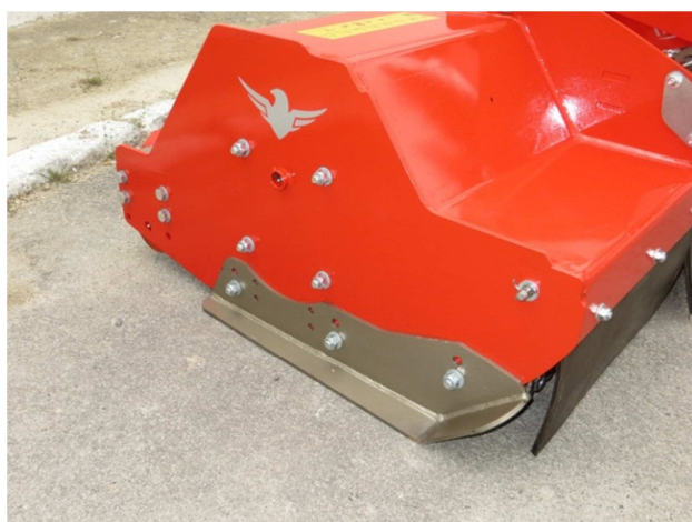
Detalle patín de deslizamiento
