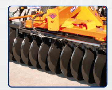
La sección delantera y trasera pueden ajustarse independientemente, permitiéndonos ajustar un ángulo mayor en el paño delantero para conseguir un buen mezclado de rastrojo y un ángulo menor en el trasero para una mejor nivelación.
