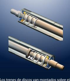
Los trenes de discos van montados sobre ejes tubulares de acero de alta resistencia, formados por dos series de rodamientos que eliminan los esfuerzos radiales y axiales. Están protegidos por un conjunto de retenes de caucho y fieltro que evitan la penetración de materias corrosivas en su interior. No necesitan engrase y son ideales para terrenos abrasivos y arenosos. Garantizados por DOS AÑOS.
