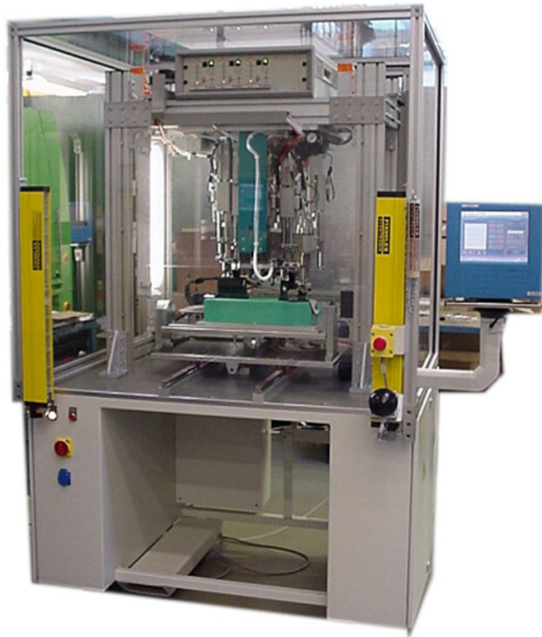
Soldadura de cubierta motor
