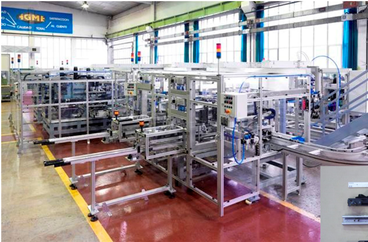
Línea de ensamblaje de guías de asiento
