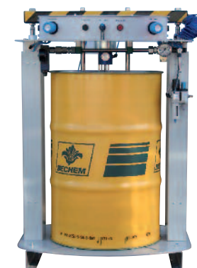
SENIOR-System Bomba elevadora de bidón para recipientes de 50 – 180 Kg SENIOR-System Barrel lifter pump for 50 - 180 kg
