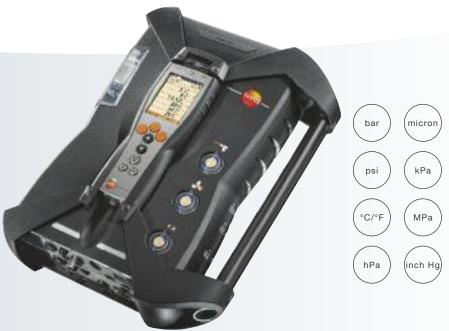
El analizador portátil de combustión testo 350 es el instrumento ideal para el analisis de gases industriales. Los intuitivos preajustes del instrumento guían al usuario a través de las tareas típicas de medición como:
