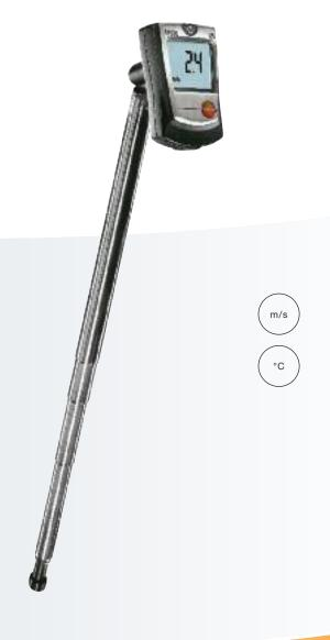
El testo 405 es un medidor de velocidad, caudal de aire y temperatura. Dispone de una empuñadura telescópica extensible hasta 300 mm y un clip de sujeción que lo convierten en apto especialmente para medir la velocidad del aire en conductos.
