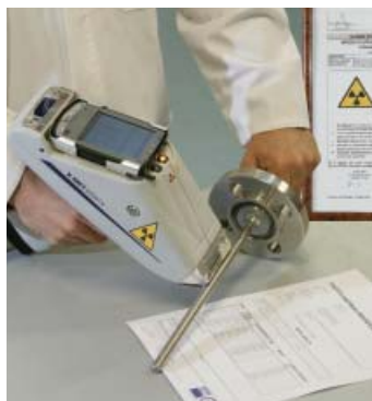
Identificación positiva del material (IPM) y control de la calidad por análisis visual
