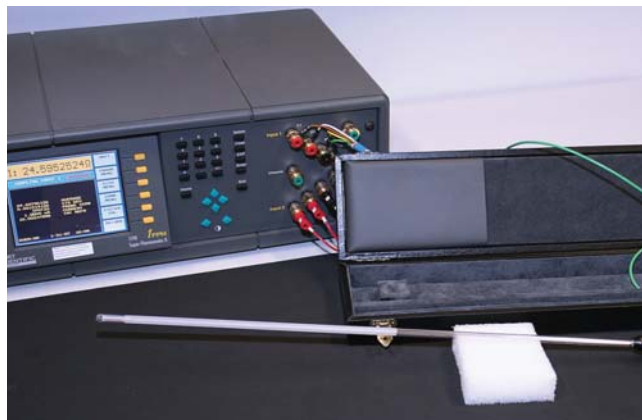
Termómetro ITS90 calibrado, termómetro de referencia SPRT (Standard Platinum Resistance Thermometer)
