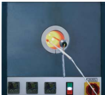
Prueba de ejecución a 900°C en un horno y prueba de presión hidrostática
