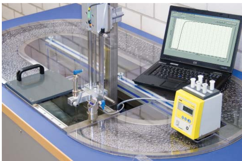
Comprobación del tiempo de respuesta de un sensor en un sistema con agua circulante
