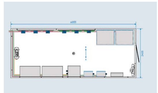
Vista superior de la estación de medición tipo container
