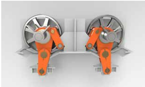
Cinematismo a moto rallentato di tipo Link Drive
