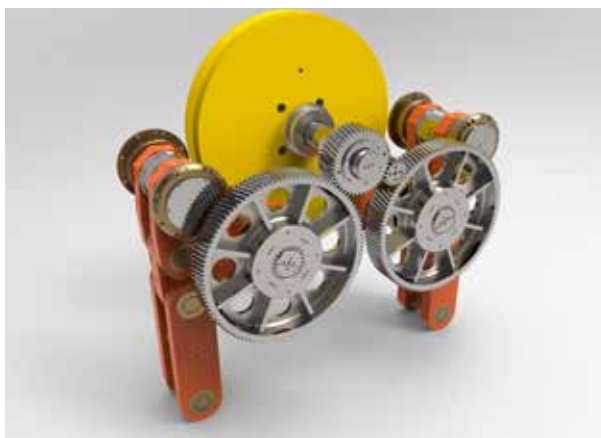
Cinematismo a moto rallentato di tipo Soft-Blanking a singola riduzione
