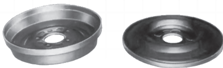
29-Ruote per autotrazione in lega di alluminio e acciaio normale, operazioni: rifilatura in orizzontale, bordatura e rullatura del bordo 29-Wheel hubs made of aluminium alloy and mild steel, operations: horizontal trimming, beading and rolling of the edge
