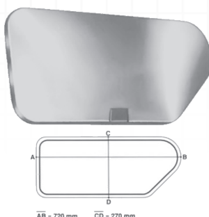
23-Piano da stiro in acciaio normale, operazioni: rifilatura e bordatura perimetro 23-Mild steel ironing board, operations: trimming and beading of the perimeter
