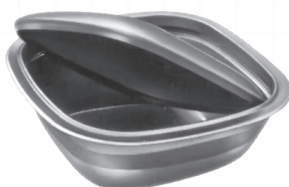
8-Pentola quadrangolare con coperchio in acciaio inox, operazioni: rifilatura in verticale della pentola e rifilatura in orizzontale e bordatura del coperchio 8-Polygonal pot with stainless steel lid, operations: vertical trimming of the pot and horizontal trimming as well as beading of the lid
