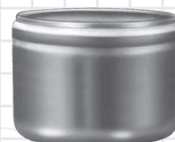
3-Pentola a pressione in acciaio inox, operazioni: rifilatura in orizzontale, bordatura e arricciatura interna del bordo 3-Stainless steel pressure cooker, operations: horizontal trimming, inward beading and curling of the edge
