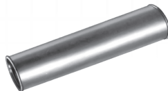
30-Silenziatore tondo in acciaio galvanizzato, operazioni: aggraffatura a 5 spessori dei fondelli superiore ed inferiore 30-Round silencer made of galvanized steel, operations: lock-seaming at 5 thicknesses of the upper and lower ends
