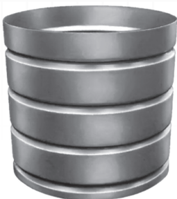
46-Contenitore per scorie nucleari in acciaio inox, operazioni: rifilatura estremità e nervature interne sul cilindro
