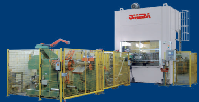
Linea di produzione con transfer per stampaggio parti di elettrodomestici / Production line with transfer for blanking parts of household appliances
