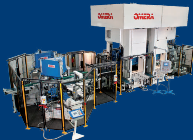
Linea automatica per pentole e coperchi inox Automatic line for stainless steel pots and lids
