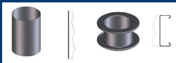
Flangiatura, punzonatura fori su flangia e semiarricciatura di corpi per ventilatori industriali. Flanging, hole punching on a flange and semi-curling of industrial fans bodies.
