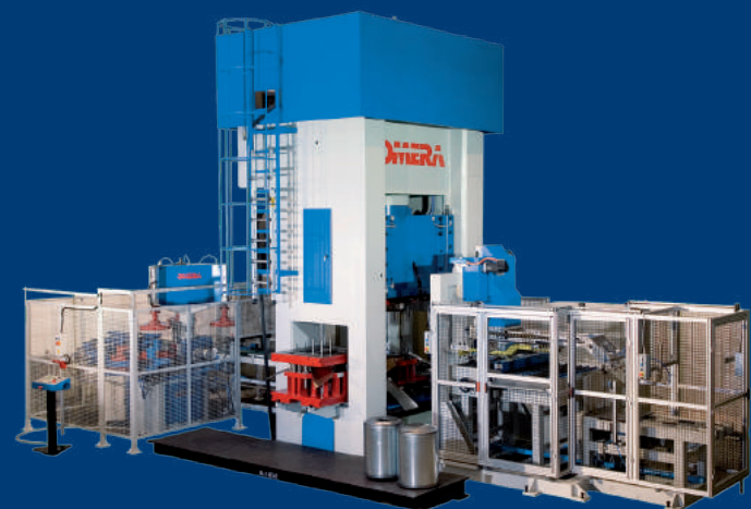
Linea automatica per la produzione di fondi Automatic line for the production of shells
