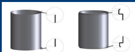
Rifilatura con altezza precisa e bordatura di camicie per pompe sommerse. Trimming with precise height and beading of submerged pumps' outer bodies.
