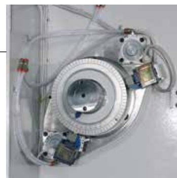
Gruppo camme e cilindri cambio corsa Cams group and stroke change cylinders
