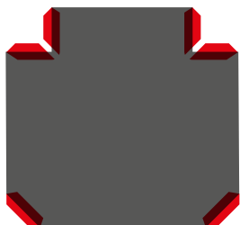
Slitta con sei guide a V
