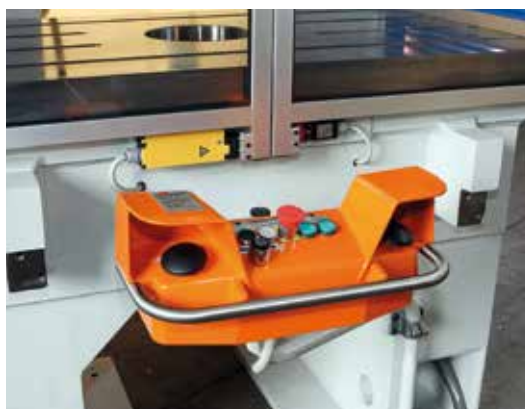
Pulpito di comando a due pulsanti Two-hand control station
