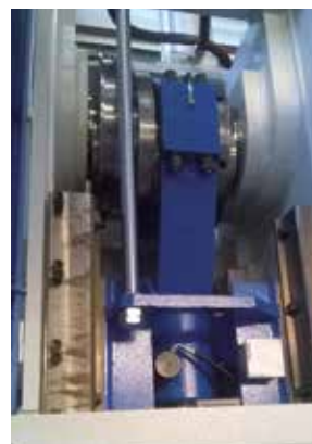
Gruppo cambio corsa-slitta Slide-stroke change unit
