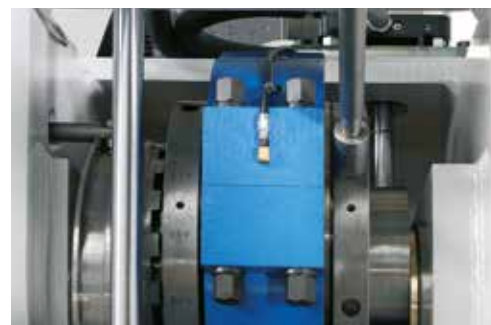
Gruppo cambio corsa con leva manuale Stroke change unit with manual lever
