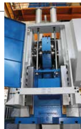
Gruppo cambio corsa-slitta motorizzata Motorized slide-stroke change unit
