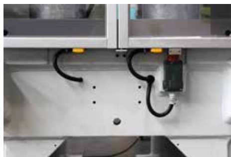
Barriere meccaniche con microinterruttore Mechanical barriers with microswitch
