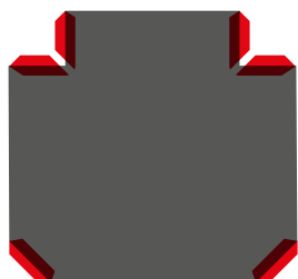
Slitta con sei guide a V
