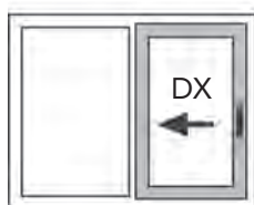
Esquema A - Elemento de 2 piezas 1 hoja corredera sobre fijo
