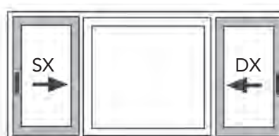
Esquema K1 - Elemento de 3 piezas 2 hojas correderas sobre practicable u oscilo
