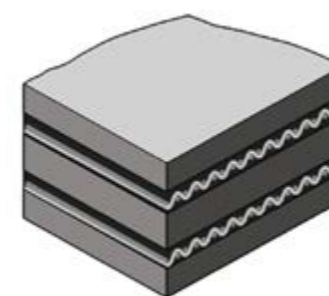
TIPO EMF Compuesto por varias capas textiles EMF
