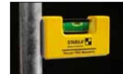
**Pocket PRO Magnetic:** nivel de burbuja profesional en formato de bolsillo, Robusta carcasa con núcleo de aluminio rectangular y dos superficies de medición fresadas con precisión y con ranura en V para mediciones horizontales y verticales. Potentes imanes de neodimio raras en las bases de medición inferior y lateral. Especialmente adecuado para trabajos en la industria metálica. Herramienta de medición auxiliar para profesionales.
