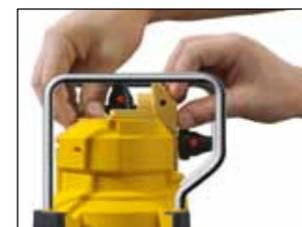
Cambio de la posición horizontal a la vertical: Toda la unidad del prisma gira de forma precisa 90° en el canal guía.
