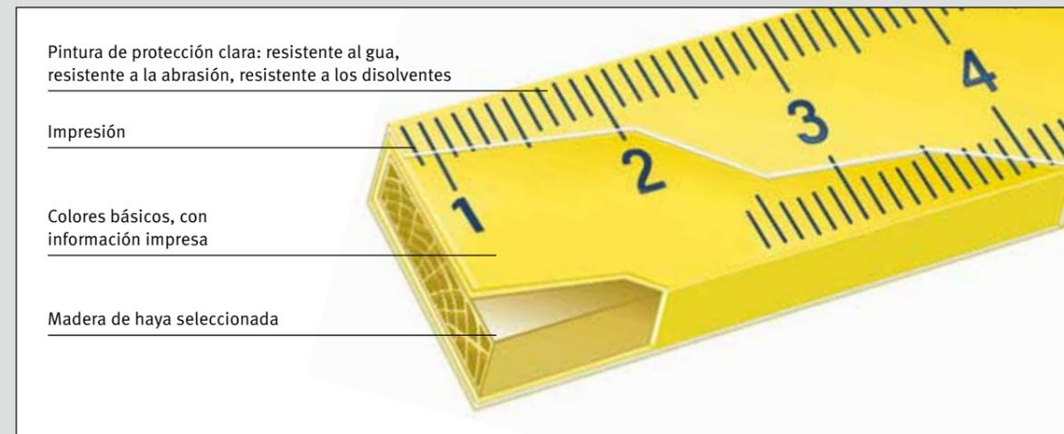
El revestimiento de los metros plegables de madera tiene que resistir todas las adversidades. por lo que se exige una protección contra la humedad, el sol y la abrasión mecánica. Solo así se asegurará permanentemente una lectura nítida.
