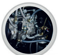
Bomba inyectora. Pompe d'injection.
