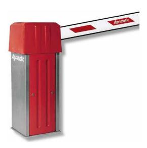
La barrera AT 166 y AT 167 están diseñadas para el control de acceso de vehículos en vías rápidas donde se requiera alta intensidad de maniobra. La potente motorización mueve un brazo de 4 y 5 m respectivamente con tiempos de apertura de 2,5 s y 9,5 s en servicio continuo. Dispone de aceleración en la arrancada y deceleración en el final de recorrido lo que disminuye la carga en el reductor prolongando la vida del sistema.
