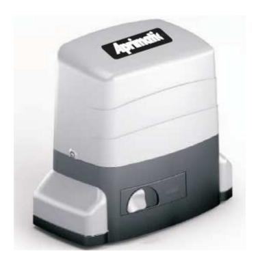
Operador de 230 Vac para puertas correderas hasta 1.200 Kg. Construido sobre un robusto monobloque de aluminio inyectado y lacado al horno con resina epoxi especial para exteriores. Dispone de un preciso encoder que facilita máximo control sobre la velocidad, fuerza y posición de la puerta. Incorpora cuadro de maniobras de fácil puesta en marcha con autoaprendimiento de los parámetros básicos de trabajo..
